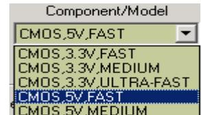
这样当你仿真时 CMOS,5V,FAST 模型自动加到 U3 的管脚。
